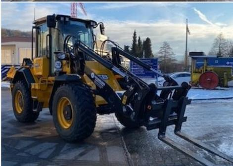
T034 Parallelhubgeometrie für High Lift Hubgerüst, Eine Parallelhubgeometrie sorgt dafür das JCB Palettengabeln nahezu parallel hochgehoben werden. Die Geometrie hat aber einen negativen Einfluss auf den Materialrückhalt in einer Schaufel, indem sie eine Auskippbewegung während dem Hub verursacht. Es führt zu einem größeren Verlust vom Material, abhängig des Schüttguts, als die Standardgeometrie.
